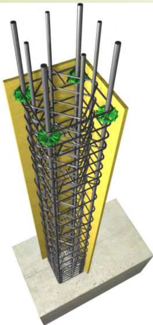
تصویر (۱-۲۴): لقمه‌گذاری روی خاموت وسط (در یک سطح) باعث تضعیف ستون می‌شود
