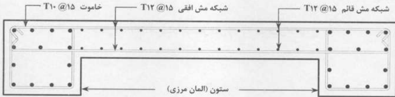
ب) پلان از مقطع دیوار برشی متصل به ستون بتنی طرفین
